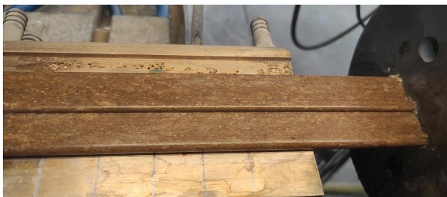
**Figura 2.** Pruebas de extrusión de material biocomposite basado en PLA en las instalaciones de Matricería Peña.
